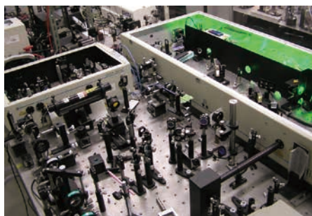
フェムト秒レーザー分光システム
