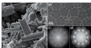
Al-Ni-Rh 正10角形準結晶の電子顕微鏡像
